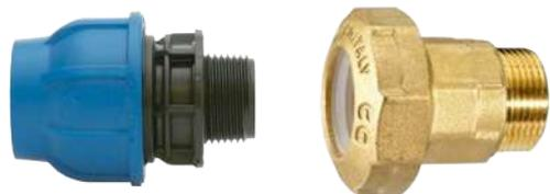
Raccordo maschio in polietilene PN16 o in ottone da 1" o 1"1/4 da avvitare sopra la valvola per innestare il tubo in polietilene.
